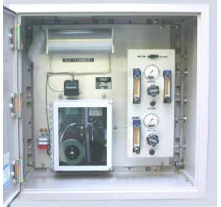
جهاز تحليل الكبريت الكلي للأغراض العامة
